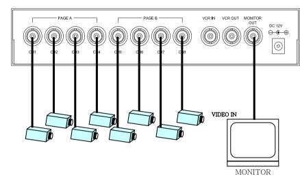
Fig 3. INSTALLATION FOR CAMERAS
